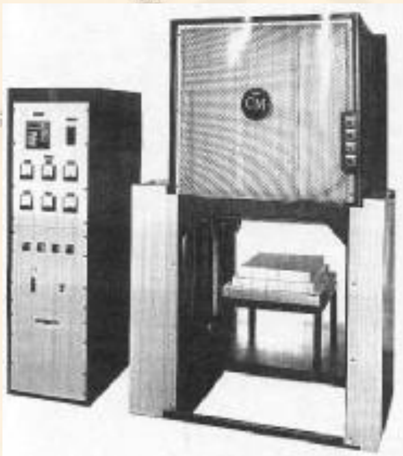
箱式电阻炉实物图 (a) 和炉体结构示意图 (b)
