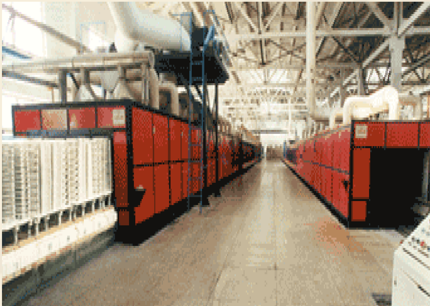
河北华玉股份有限公司78m日用瓷 宽断面明焰隧道窑
